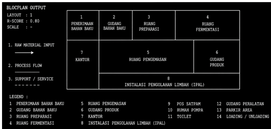
Gambar 1. Layout unit pengolahan dari aplikasi Blocplan .
